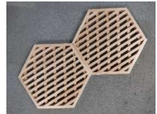
音響調整と意匠性を確保するため 木材(角材)の間隔と角度を変えて二段重ねしたパネル
