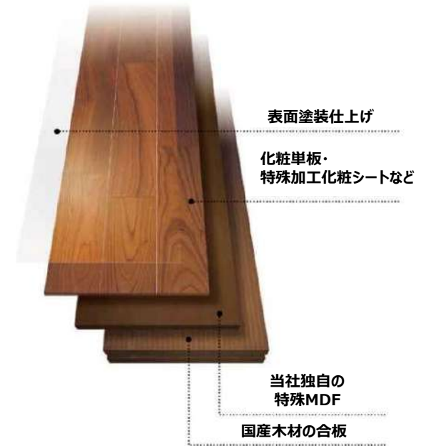
国産木材を用いた床材の断面イメージ
