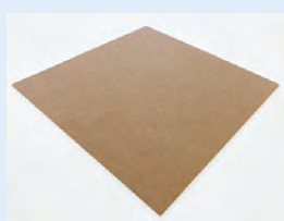
木質由来の接着剤を用いたMDF試作品
