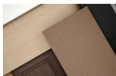
製材端材などを 原材料として活用した MDF
